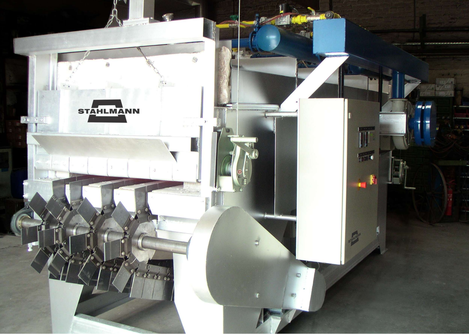
Kettendurchlaufofen zur Wärmebehandlung mit vier Deckenstrahlbrennern. Einsatztemperaturen: bis 1000 °C
